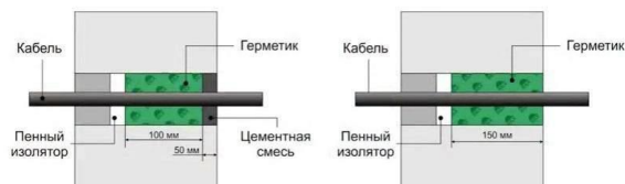
ВАРИАНТЫ ЗАПОЛНЕНИЯ ГЕРМЕТИКОМ ВВОДА
